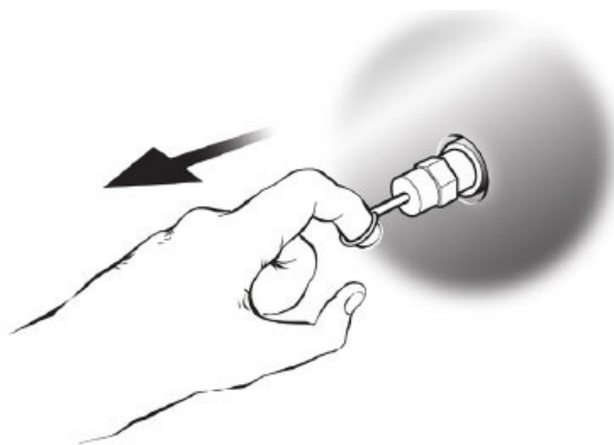
Fig. 21: Supapă de siguranță cu inel
