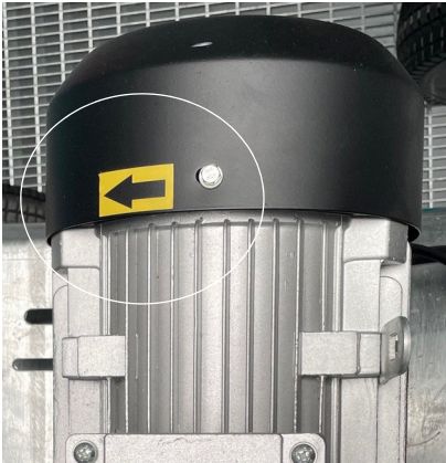
Abb. 5: Direcția de rotație
