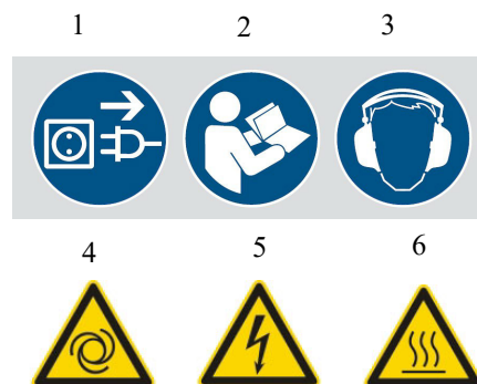
Fig. 1: Semne de obligativitate (1 Scoateți ștecherul din priză/2 Respectați instrucțiunile/3 Purtați protecție auditivă) | Avertismente (4 Avertisment referitor la pornirea automată/5 Avertisment de tensiune electrică periculoasă/6 Avertisment privind suprafața fierbinte)
