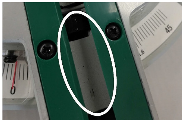
Img. 15: Deteriorarea ferăstrăului datorită reglării incorecte a adâncimii
