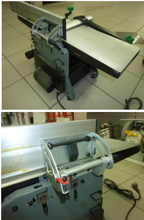
Fig. 26: Reglare opritor din aluminiu
