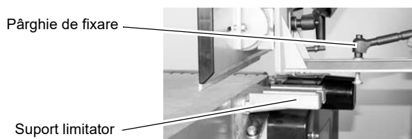
Fig. 15: Montarea limitatorului pe masa de preluare
