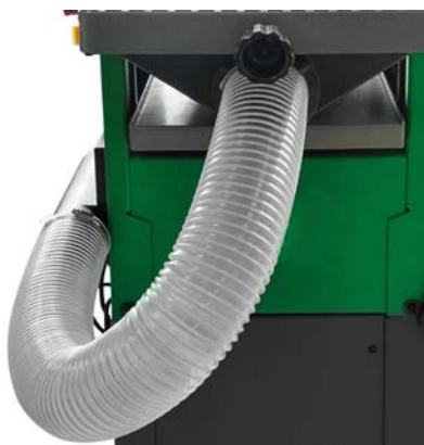
Fig. 15: Montarea furtunului de aspirare
