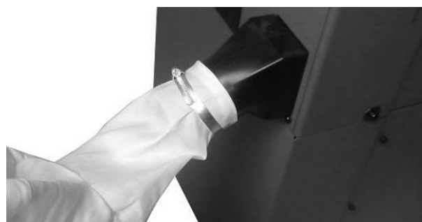
Fig. 14: Asamblarea sacului pentru așchii din lemn
