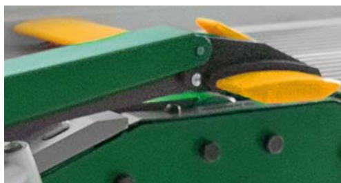
Fig. 2: Protecție tip punte a arborelui de rindeluit
