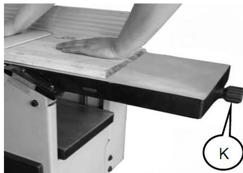
Img. 22: Setarea scoaterii așchilor din lemn
