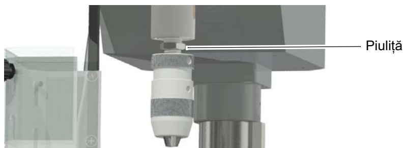
Img.4-2: Piuliță pentru slăbirea conectării DX13V
