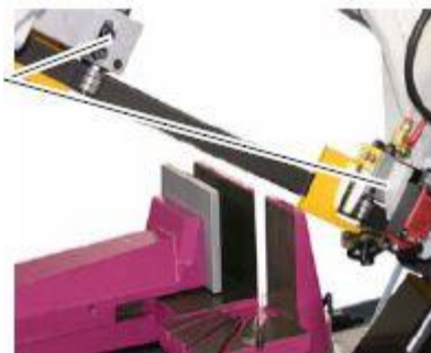
Fig 4-2: Ghidaj al benzii ferăstrăului
