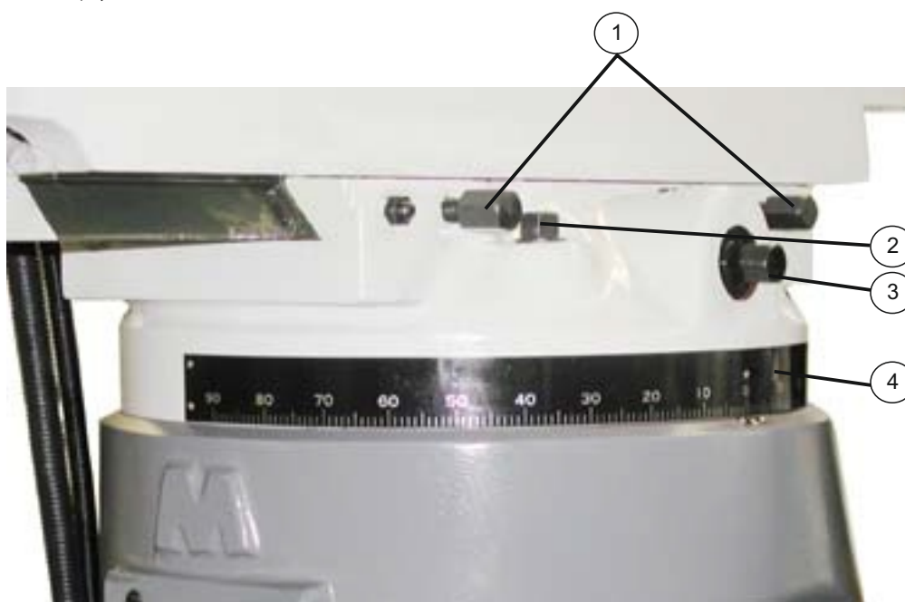
Img.4-15 Deplasarea suportului capului portsculă înspre înainte și înapoi
