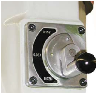
Img.4-23: Comutator selector - Viteza de avans a pinolei arborelui
