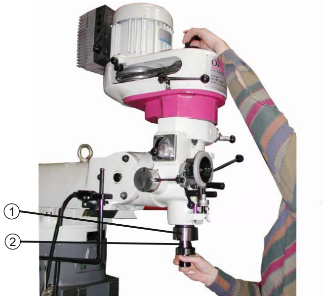
Img.4-26: Fixarea uneltei de prelucrare
