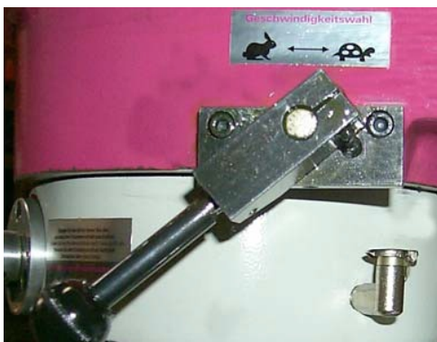
Img.4-18: Comutatorul de viteze
