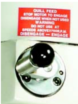
Img.4-24: Comutator pornit/oprit pentru viteza de avans a pinolei arborelui
