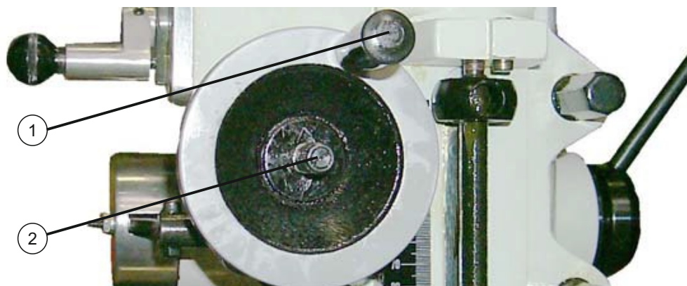
Img.4-22: Roată manuală pentru reglarea fină
