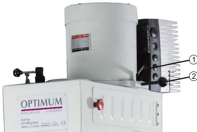
Img.4-17: Reglarea vitezei arborelui pe cureaua de antrenare
