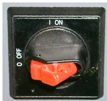
Img.4-6 Comutatorul principal
