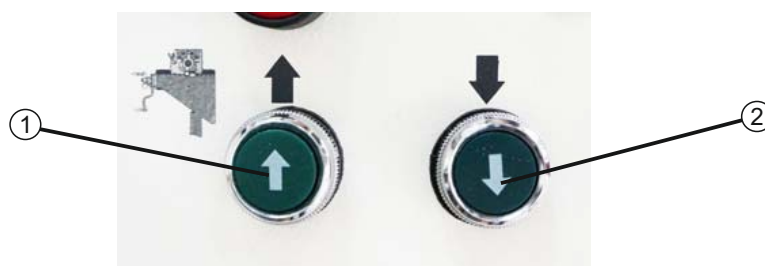
Img.4-9 Ridicarea/coborârea mesei transversale cu ajutorul panoului de control
