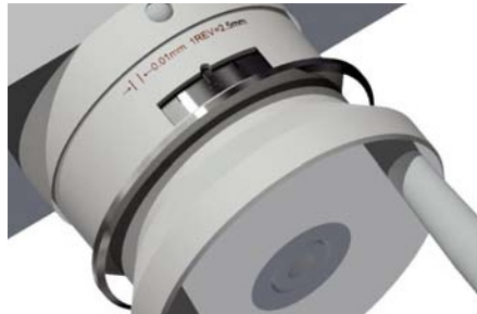
Pозиция метричa a inelului cu scală pe sania superioară
