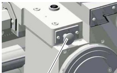
Pompă lubrifiere centrală
