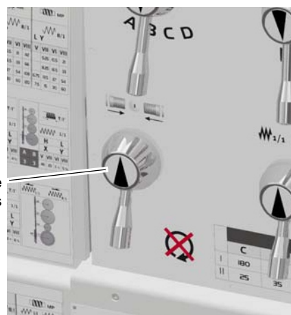
Img.4-3: Panoul de control de pe păpușa fixă
