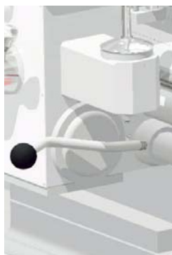
Manetă de schimbare a direcției de rotație
