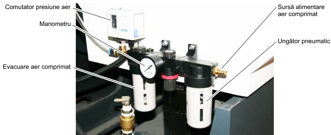
Img.3-8: Unitate de întreținere aer comprimat
