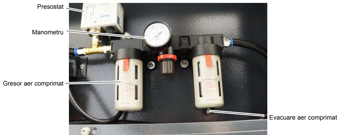
Abb.3-2: Unitate de întreținere aer comprimat
