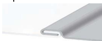
Îmbinare cu îndoire simplă
