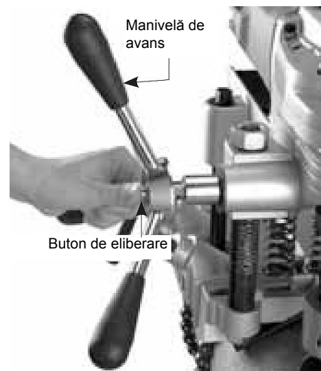
Fig. 6: Montarea manivelei de avans
