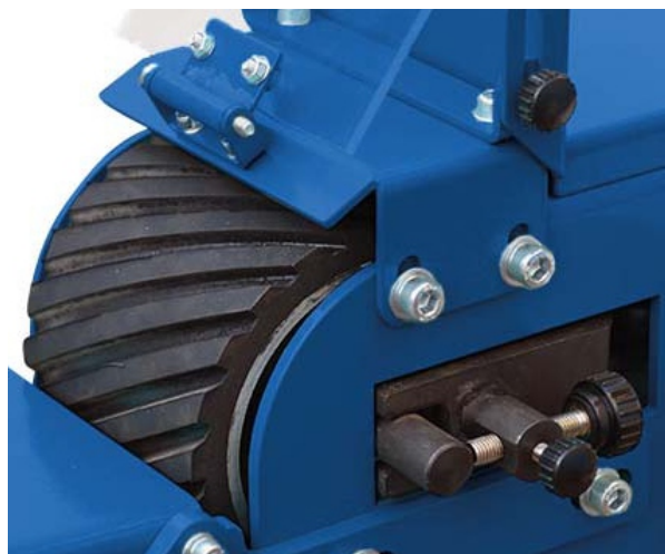
Fig. 12: Tensionarea benzii abrazive
