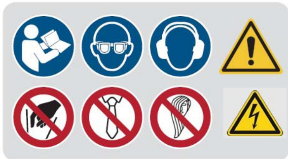
Fig. 1: Etichete siguranță - Simboluri obligatorii: Citii instrucțiunile, Purtați ochelari de protecție și antifoane | Simboluri de avertizare: Semne generale avertizare | Tensiune electrică | Simboluri de interdicție: Nu atingeți, Nu purtați cravată, Nu purtați părul desfăcut
