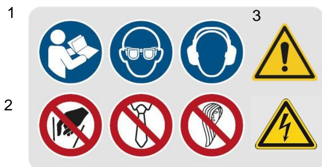
Fig. 1-1: Etichetă referitoare la siguranță – 1 Semne de obligativitate: Respectați instrucțiunile de utilizare, Folosiți ochelari de protecție, Folosiți antifoane | 2 Semne de interdicție: Introducerea mâinilor interzisă, Purtarea cravatei în timpul utilizării interzisă, Operarea cu păr lung interzisă | 3 Semne de avertizare: Semne generale de avertizare, Avertisment cu privire la tensiunea electrică
